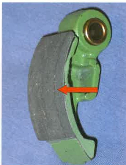
Figura 6 - Ganascia del freno roccatrice smontata: si nota la spessa guarnizione in materiale amiantifero
