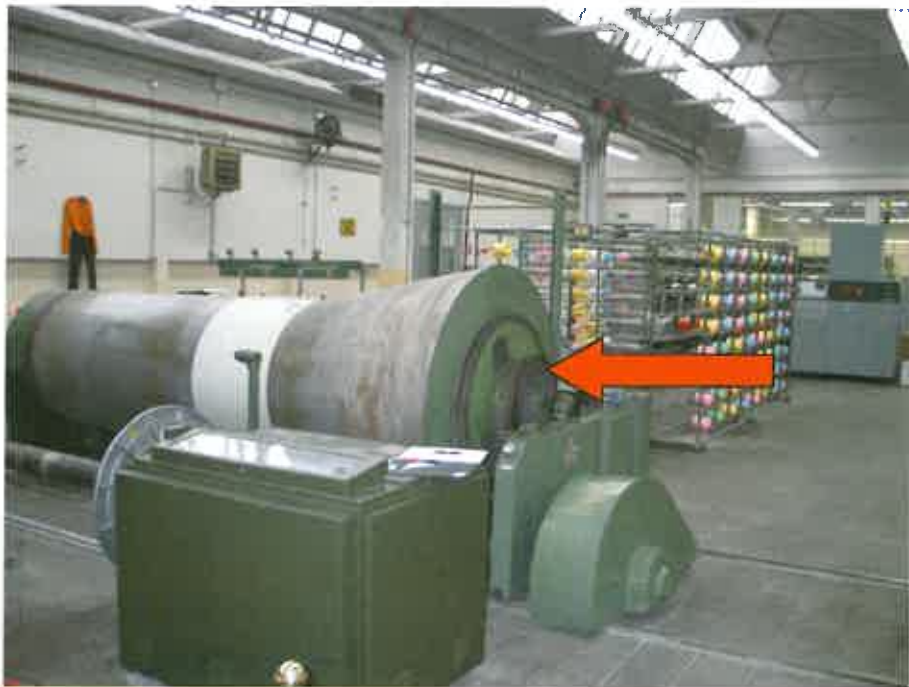
Figura 7 - Orditoio, utilizzato fino all'anno 2000: la freccia indica il potente freno a disco, di tipo ferroviario. Sullo sfondo la cantra caricata di rocche
