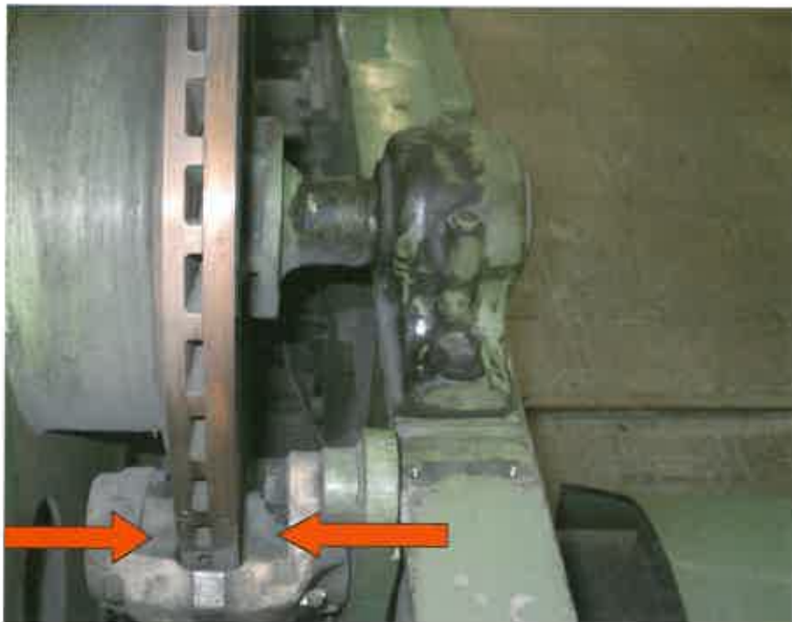
Figura 8 - Ingrandimento della figura precedente: disco, pinza frenante, pastiglie d'attrito e polvere fine prodotta dall'usura delle stesse
