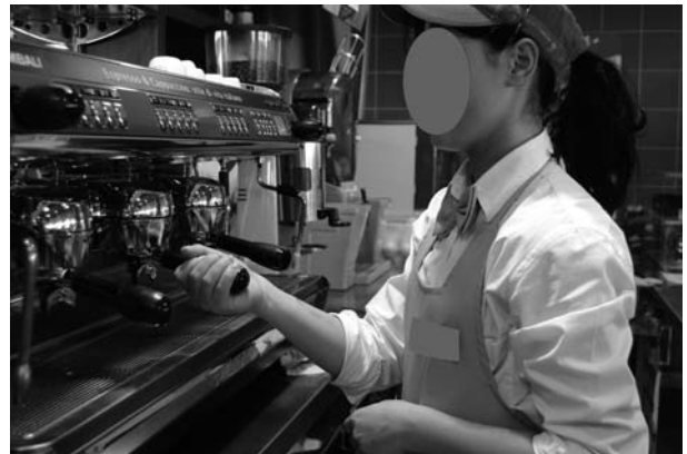
Figura 1 - Inserimento del gruppo di filtrazione del caffè Figure 1 - Connection of unit of filtration coffee
