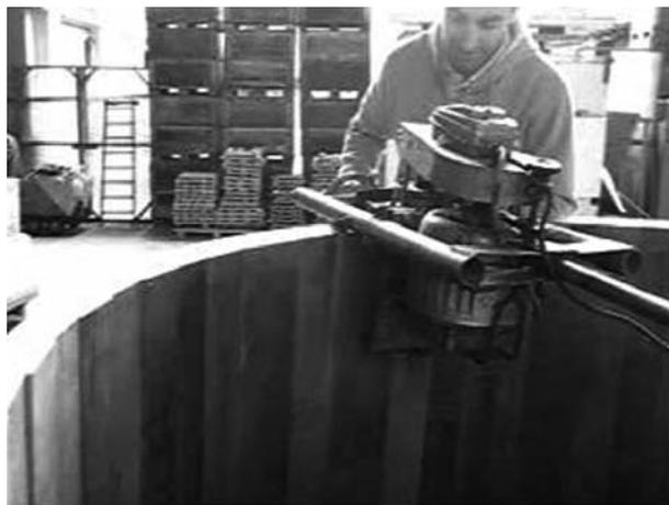
Figure 10 - Realizzazione della caprugginatura
