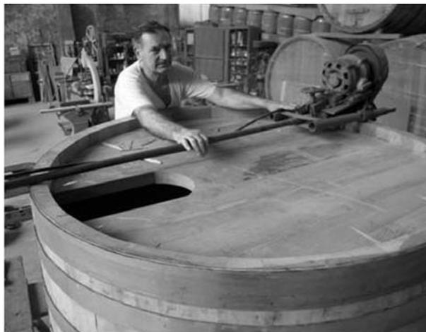
Figure 11 - Realizzazione della caprugginatura
