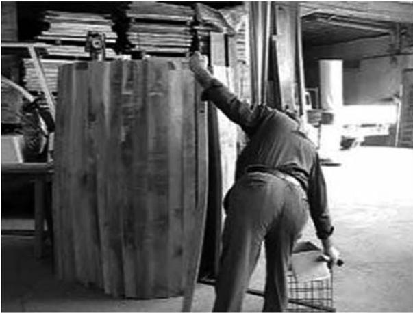
Figura 6 - Primo assemblaggio della botte
