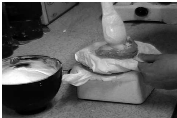
Figura 2 - Colatura del gesso su vibratore Figure 2 - Pouring plaster on vibrator
