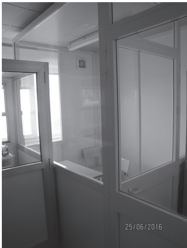
Figura 1 - Camera di esposizione per il test di provocazione bronchiale specifica
