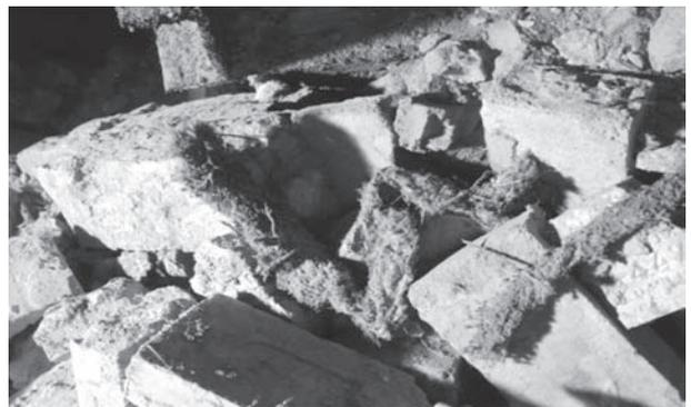
**Figura 4** - Particolare del materiale fibroso tipo corda disperso a terra e proveniente dall'isolamento delle tubature
