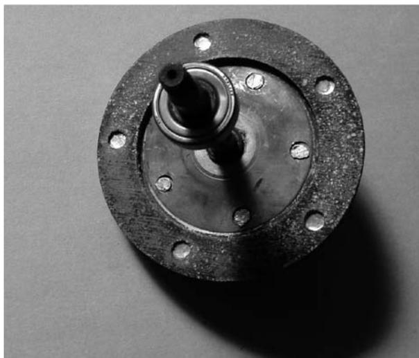
**Figura 2** - Motore e frizione in amianto di macchina da cucire
