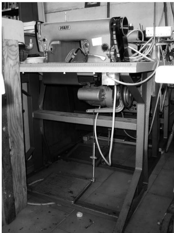
**Figura 1** - Macchina da cucire di tipo industriale e collocazione motore
