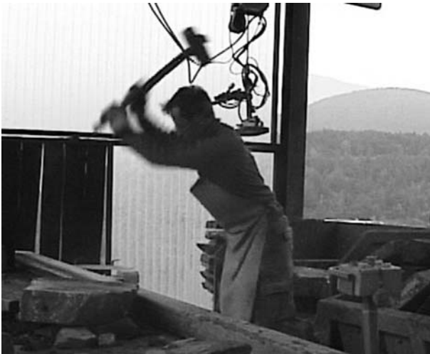
Figura 3 - Lavorazione con bancone tipo B: l'altezza della pedana può essere regolata con un semplice comando, mantenendo la posizione corretta e la forza necessaria
