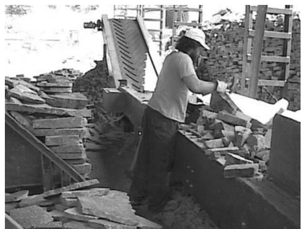
Figura 2 - Lavorazione con bancone tipo A: l'operaio si trova a lavorare il materiale davanti a lui, stando diritto in piedi in appoggio stabile sugli arti inferiori
