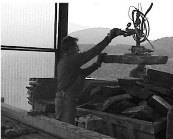
Figura 6 - Lavorazione con bancone "modello B" caratterizzato dalla presenza di sistemi di presa con ventose a depressione per la movimentazione delle lastre
