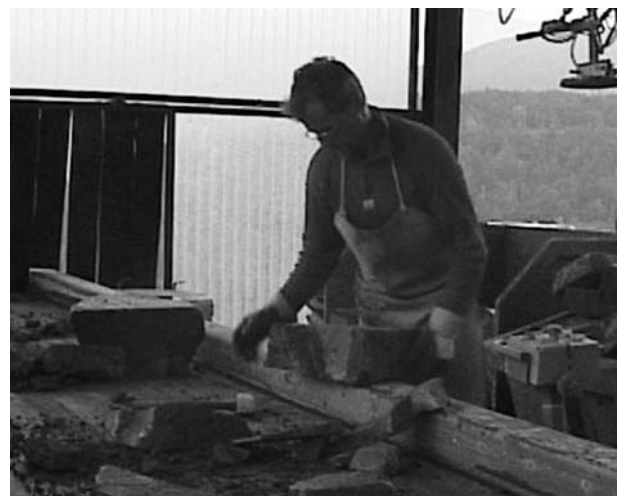
Figura 4 - La lavorazione con bancone permette strategie ergonomiche tipo l'appoggio della parte alta delle cosce che facilita la movimentazione ed il sollevamento delle lastre
