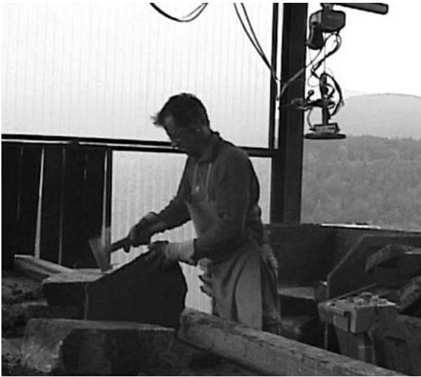
Figura 5 - Lavorazione con bancone "modello B" caratterizzato dalla pedana regolabile in altezza
