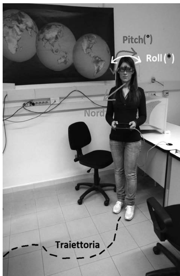
Figura 4 - Esempio di ricostruzione della posizione dell'operatore con il dispositivo montato sugli occhiali
