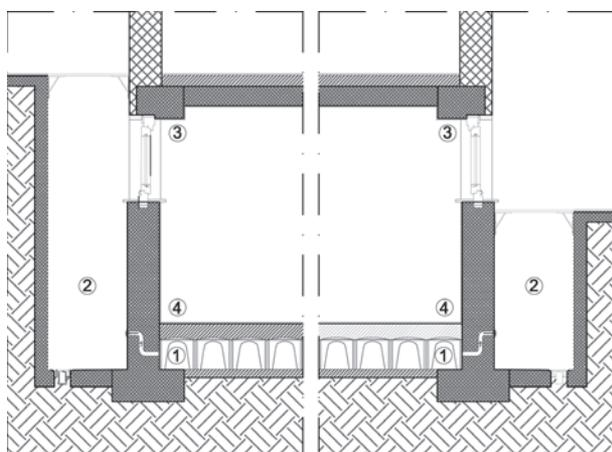
**Figura 2.** Sezione tecnologica di un piano interrato (a sx) e di un seminterrato (a dx), in cui vengono evidenziati: 1. Vespajo aerato, che ha la funzione di contrastare il gas radon; 2. Intercapedine, per evitare umidità e garantire il ricircolo dell'aria; 3. Finestre, per garantire il corretto ricambio dell'aria e ventilazione naturale dei locali; 4. Materiali di finitura e arredi degli interni
