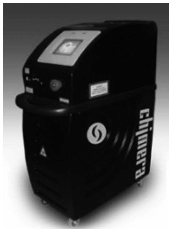
Fig. 4. Laser Nd:YAG 1.064 nm (Elettronica Valseriana)
